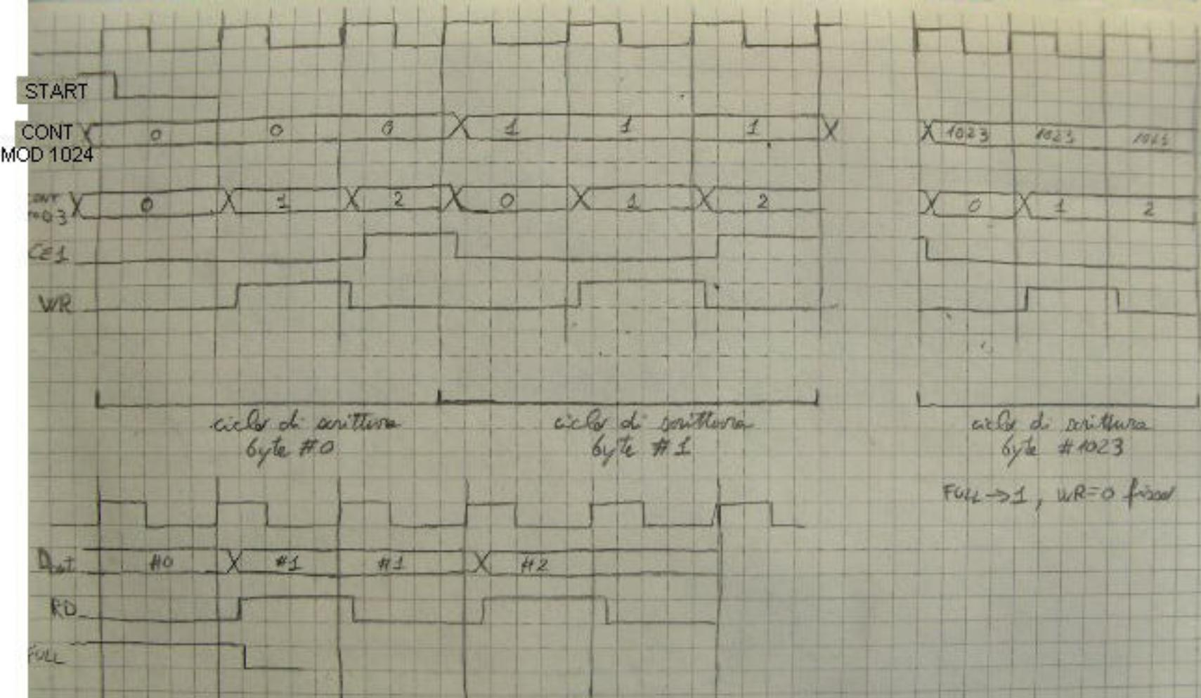
I quattro registri si caricano un clock sì e uno no; il contatore modulo 4 nel progetto può essere sostituito con uno modulo 8 con le uscite del decoder collegate una sì e uno no.
