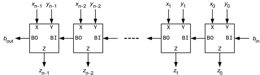
dove  $X = x_{n-1}x_{n-2} \dots x_1x_0$  e  $Y = y_{n-1}y_{n-2} \dots y_1y_0$  sono i due operandi, detti rispettivamente *minuendo* e *sottraendo*, mentre  $Z = z_{n-1}z_{n-2} \dots z_1z_0$  è la *differenza*.
