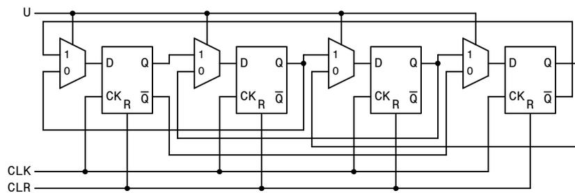
Allo stesso circuito si può pervenire in modo più rapido se, nel diagramma di stato, si osserva che la sequenza di conteggio per  $U = 0$  può essere ottenuta da quella per  $U = 1$  semplicemente rovesciando l'ordine delle variabili di stato ( $Q_0Q_1Q_2Q_3 \rightarrow Q_3Q_2Q_1Q_0$ ). Ciò significa che, essendo la struttura del contatore Johnson a 4 bit la seguente:
