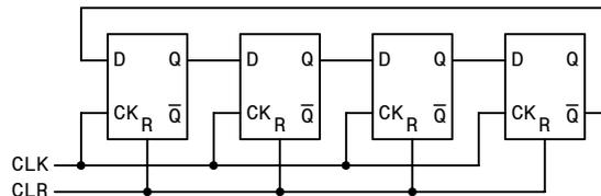
la struttura del corrispondente contatore Down si ottiene da essa semplicemente invertendo l'ordine dei flip-flop e lasciando immutate tutte le interconnessioni:
